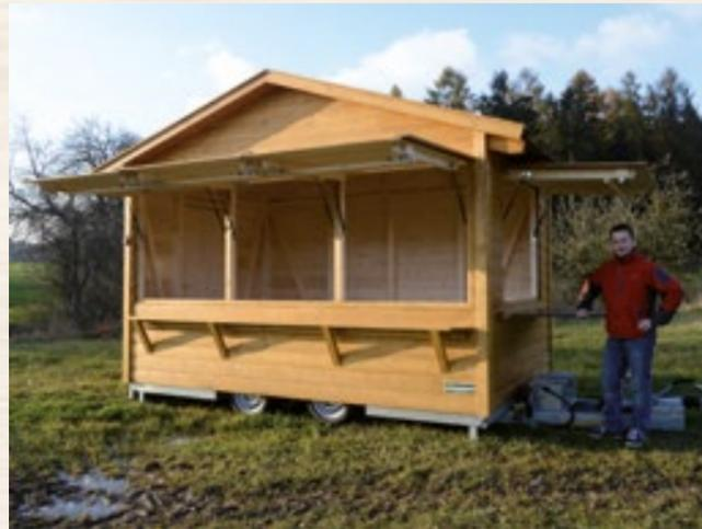
Absenkbarer Hänger im abgesenkten Zustand
