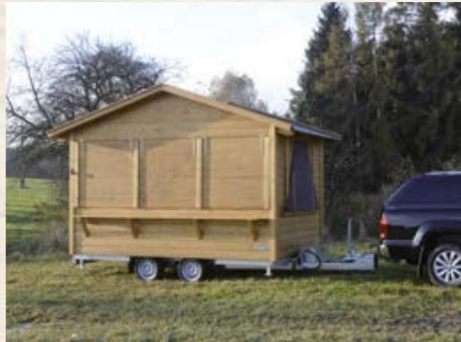
Absenkbarer Hänger im gehobenen Zustand
