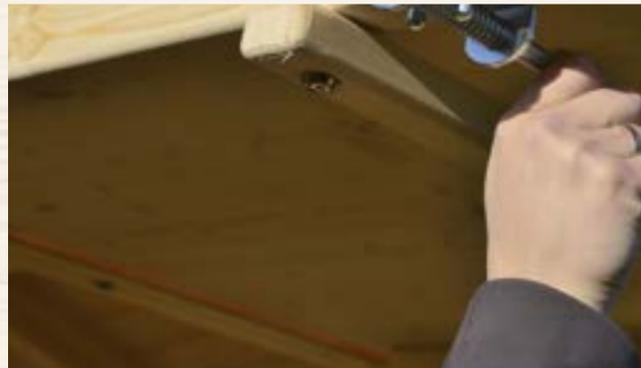
Schnellverschluss durch Federrigel
